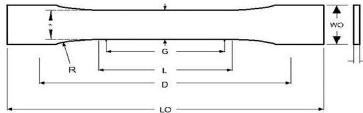
Fig. 2. Tensile Test Specimen
