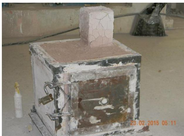
**TESTFIRING OF THE PROTOTYPE GAS FIRED KILN**
