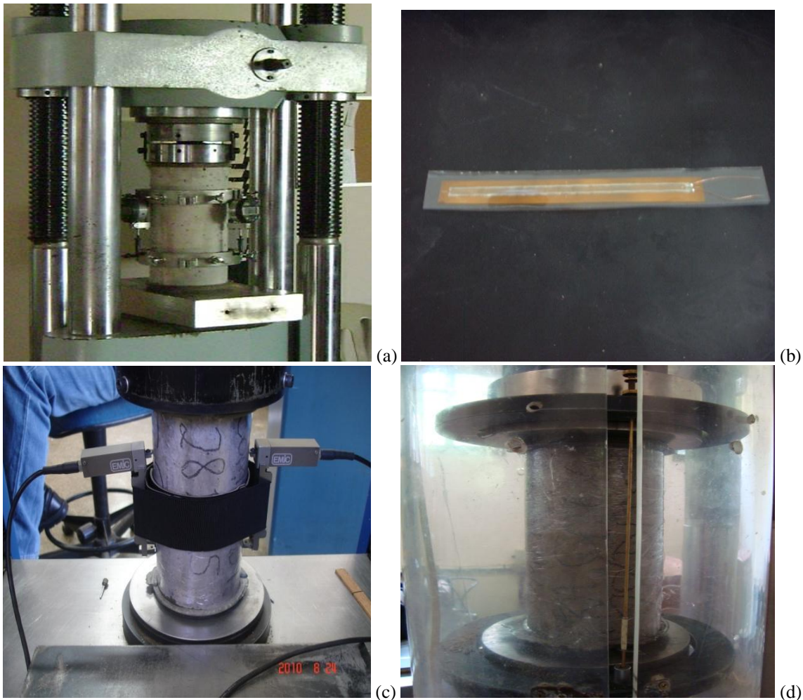
FIGURE 2 – Dial Indicators (a) Strain gage (b), Clip gage (c) and LVDT (d)
