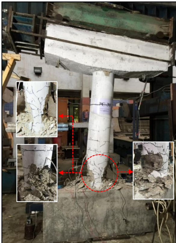
(d) Specimen PC-30 at Failure
