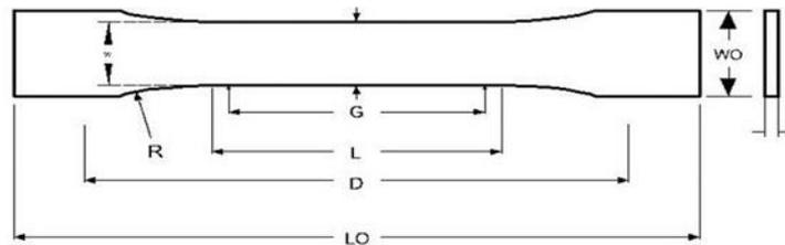
Fig. 2. Tensile Test Specimen
